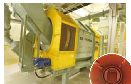
4 可燃・不燃選別装置 破砕物を円筒の回転式ふるいにかけて、粒度差によって不燃物・可燃物に分別します。
