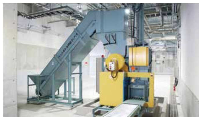
8 ペットボトル圧縮梱包機 回収されたペットボトルを圧縮し梱包します。
