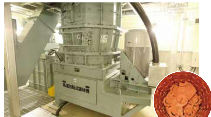
2 高速回転式破砕機 高速回転するリングハンマーでゴミを細かく破砕します。
