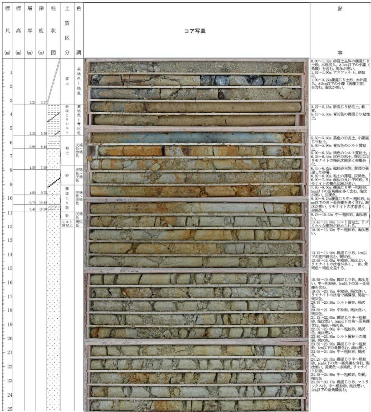
図 2-7(1) ボーリングコア写真・柱状図 (MW - 2孔) (1 / 2)
