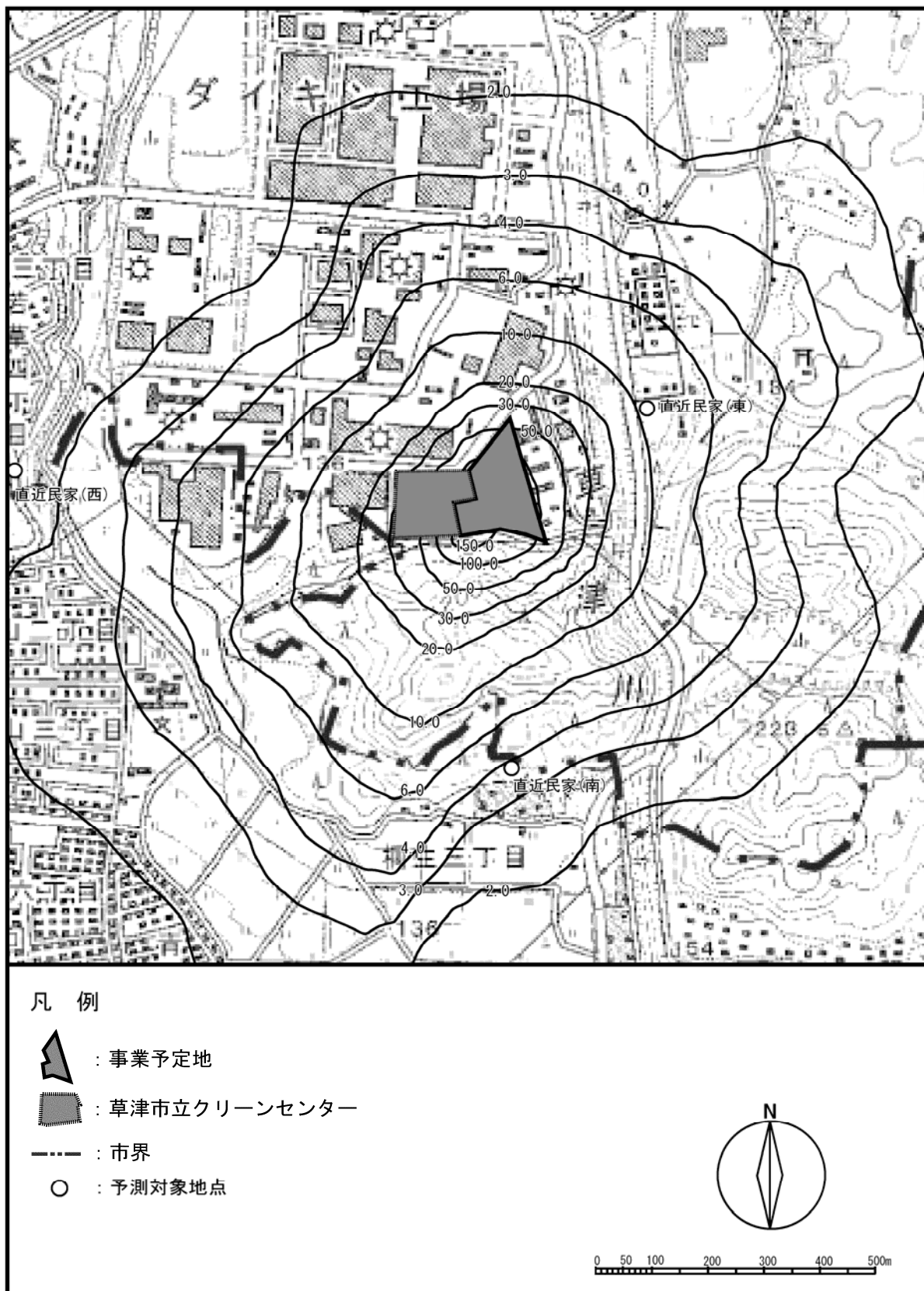
図 7-1-10 工事中の建設機械の稼働に伴う排出ガスの予測結果 (NOx 寄与濃度 : ppb)
