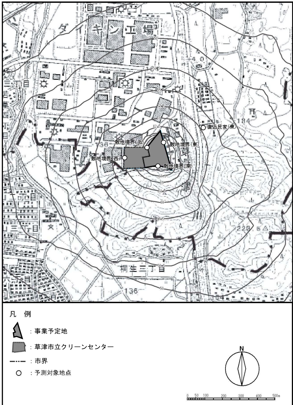
図 7-2-6 工事中の建設機械の稼働に伴う騒音の予測結果 (dB)
