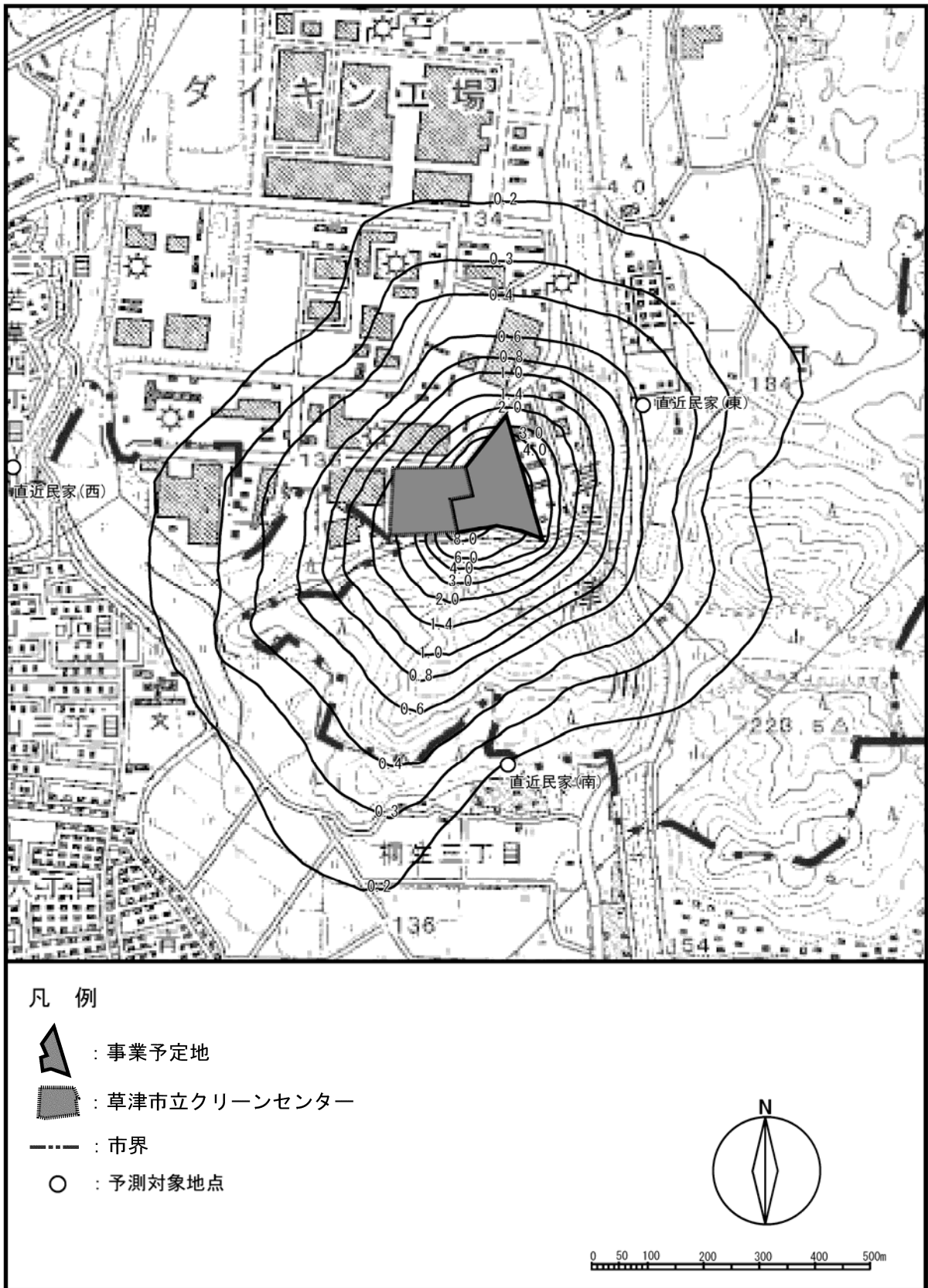
図 7-1-11 工事中の建設機械の稼働に伴う排出ガスの予測結果 (SPM 寄与濃度 : \mu\text{g}/\text{m}^3 )
