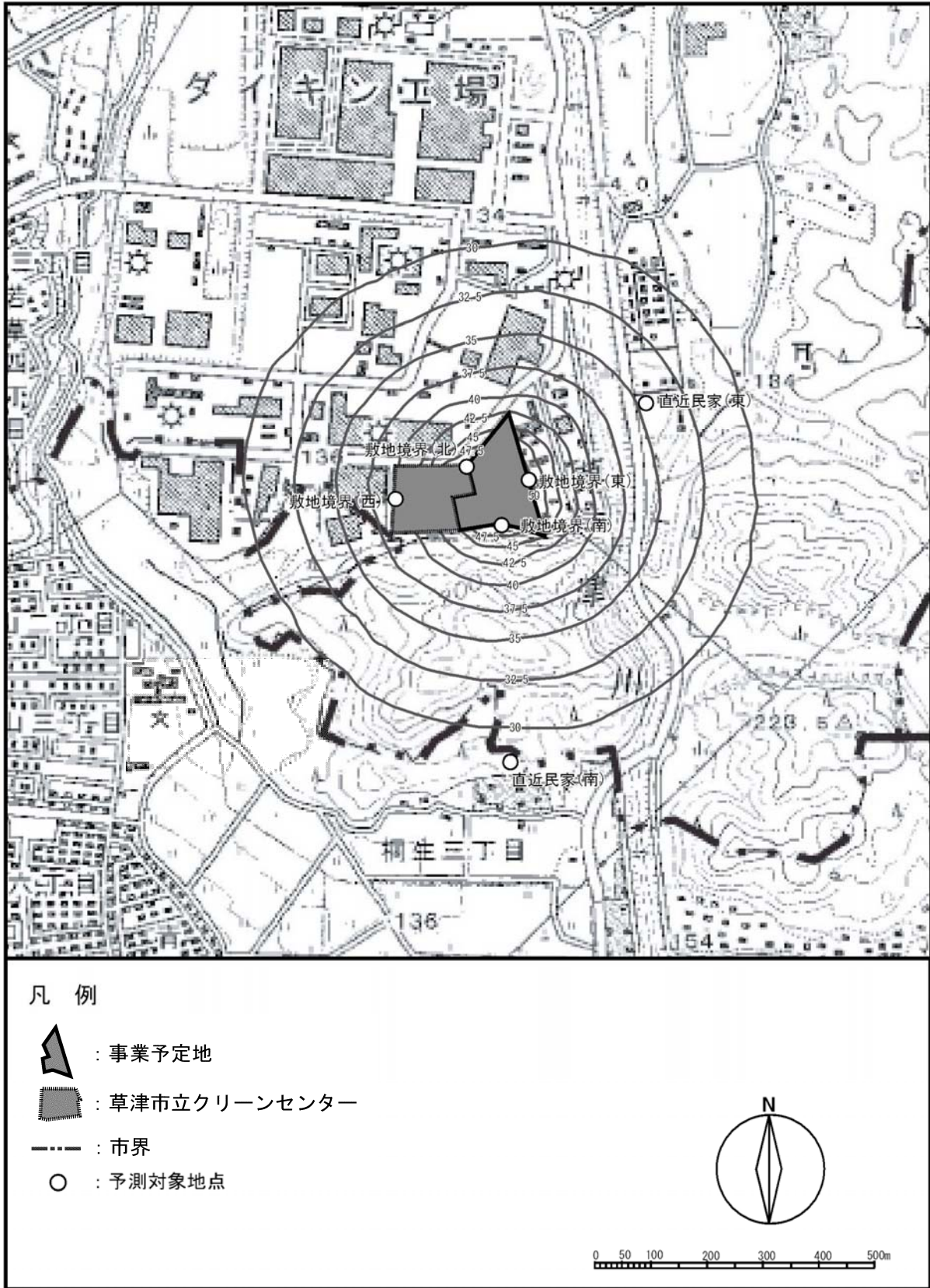
図 7-2-9 供用時の焼却施設等の稼働に伴う騒音の予測結果 (dB)
