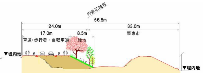
図-13 標準断面図 (区間⑥)
