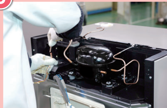
コンプレッサーを取りつける。
