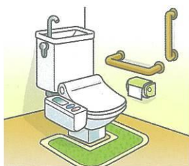
手すりの設置
