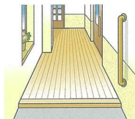
廊下幅の確保
