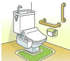
手すりの設置
