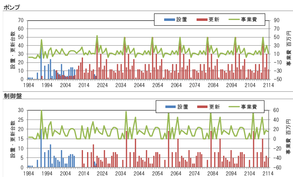
図 2-10 マンホールポンプの整備状況と更新事業量の試算結果（単純更新）
