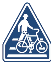
横断歩道と自転車横断帯 横断歩道と自転車横断帯が近接した場所に設置されていることを示す。
