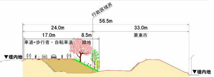
図-13 標準断面図 (区間⑥)
