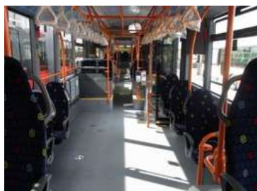
【床全面が平坦なバリアフリー対応。スロープで乗降が可能な仕様】 出典：岐阜市HP
