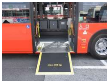
【床全面が平坦なバリアフリー対応。スロープで乗降が可能な仕様】 出典：岐阜市HP
